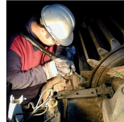
Шлифование участков питтинга на профиле зубьев шаровой мельницы
