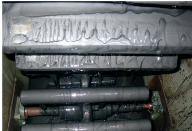
Открытая передача с вспомогательной шестерней нанесения смазки Berulit GA 2500 Fluid
